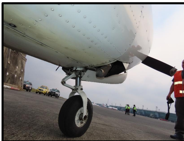
Fotografía No. 10 Vista del tren de nariz de la aeronave.
